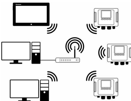
I dispositivi PQM-710 e PQM-711 hanno il **ricevitore GPS** integrato che garantisce un'elevata precisione dell'orario e il **modem GSM** che facilita l'esecuzione delle misure da remoto. Il PQM-711 è munito di un **registratore di transienti** (frequenza di campionamento 10MHz, portata delle tensioni **fino a  $\pm 8000$  V**).
